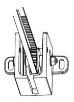
Fácil ajuste de la tensión de la cinta, tanto en la parte del retorno, como en la caja tractora( en este último caso por el inferior de dicha caja)
